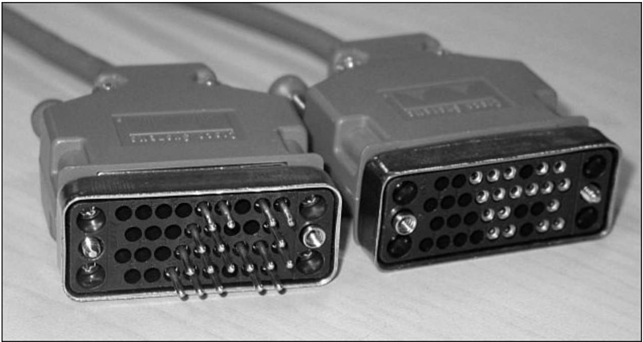
Figure 4-6. V.35 DTE and DCE Cables
